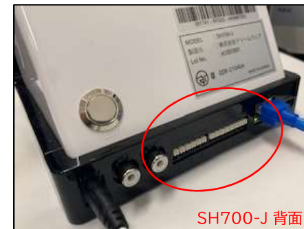
【SH700-J 外部機器制御用接点端子】
